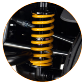
Telescopische schokdempers aan de achterzijde
